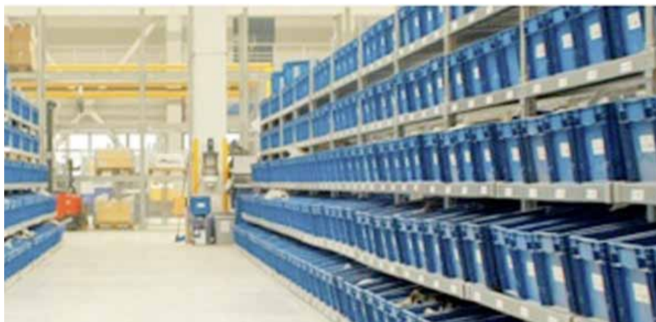
Depozitarea subansamblelor modulelor termice etichetate prin sistemul CANBAN
