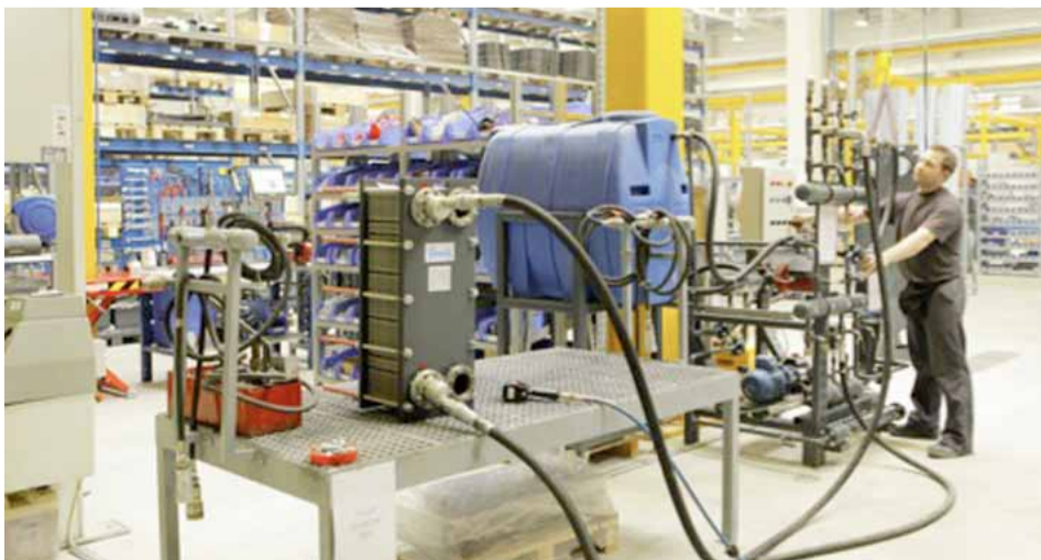
Încercarea hidraulică a schimbătorului de căldură
